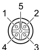
図10： 「RS-485」コネクタ（5ピンBinder M12ソケット）
