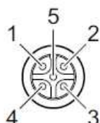
図 12： RS-485 接続（5ピン M12 ソケット）
